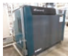
蒸気コンプレッサー
